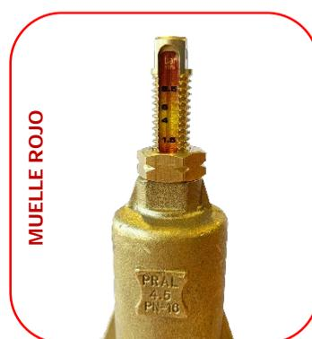
Cometal ha diseñado unas escalas de presión para cada piloto en particular. Dichas escalas de presión quedan insertadas en forma de regla en cada tornillo superior del piloto, de tal manera que estamos informados de la presión a la que el piloto regulador de presión queda pre-tarado antes incluso de su uso.
