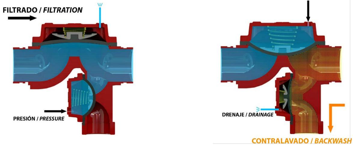
En condiciones normales de trabajo (suministro a filtro), la cámara inferior permanece cerrada, pasando el agua hacia el filtro con paso libre de cualquier obstáculo (eje o pistones).
